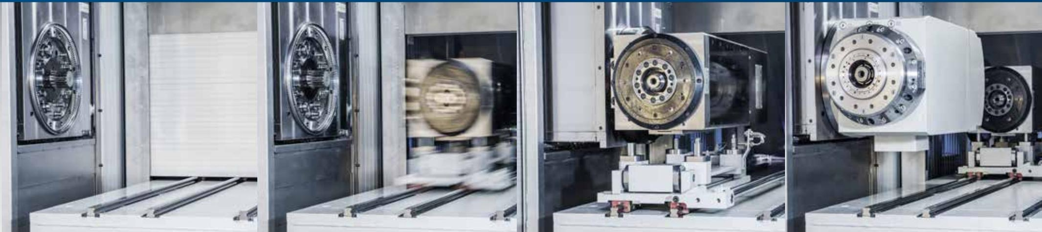
Para economizar tempo e custos de fabricação e maximizar a produtividade, o mpmc pode completar uma peça inteira com apenas um número mínimo de configurações. Tem a capacidade de realizar todas as tarefas de usinagem normalmente processadas por diversas máquinas diferentes, o que o torna altamente versátil. Múltiplos cabeçotes de usinagem são estocados em uma estação de troca e ficam disponíveis para serem
